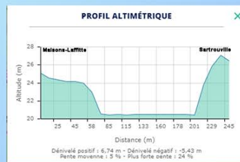
Profil altimétrique de rive à rive entre Sartrouville et Maisons-Laffitte. On constate instantanément l'asymétrie entre les deux rives. D'un côté, la rive de Maisons-Laffitte, peu aménagée et vulnérable aux crues. De l'autre côté, Sartrouville avec sa digue, à une rive plus haute que celle de Maisons-Laffitte, d'environ 0,6 mètres.
